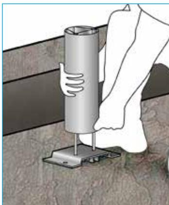
**4** - Avant de poser votre isolant, enfiler les tubes avec les tiges filetées dans les 2 parties circulaires prévues pour cet effet.
