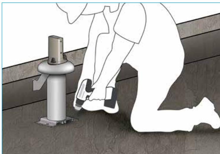
1 - Les embases sabot D sans manchon d'étanchéité sont livrées prémontées. Fixez les sabots D sur la dalle tous les 1500 mm maximum selon préconisations avec chevilles chimiques M10 Chimfort ATE STD IN M10 ou chevilles mécaniques du type Baraco crack FM 75 M10.
