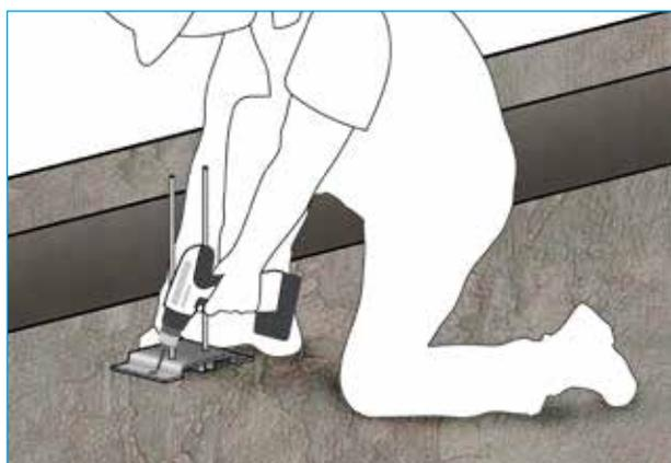
**3** - Fixez les plaques de fixation tous les 1500 mm maximum selon préconisations avec chevilles chimiques M10 Chimfort ATE STD IN M10 ou chevilles mécaniques du type Baraco crack FM 75 M10.
